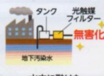
タンク 光触媒 フィルター 無害化 地下汚染水 水中に融けた 汚染物質の分解・除去
